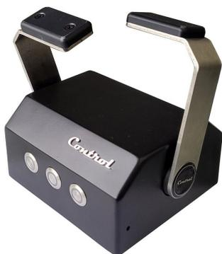
Os manetes de controle CONTROL, são confeccionados em chassi de aço inox 304, capa em ABS, as partes mecânicas são usinadas em poliacetal, as alavancas de comando são em aço inox 304 com acabamento escovado os botões de acionamento de inox a prova de água e todos os parafusos em inox.
