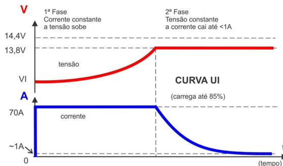
Funcionamento: Ao ser exigido qualquer consumo da(s) bateria(s), ou estiverem com baixa carga, o carregador entra automaticamente para fornecer a corrente solicitada até o máximo de sua capacidade, sendo que cessado o consumo ou baterias carregadas completamente, o carregador passa novamente a condição de flutuação.
