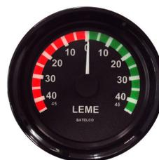
O indicador de ângulo de leme RUDDERBOX é composto por uma central de processamento que recebe informação de nosso sensor de leme AL45 e tem saída para instrumentos análogos de 52 e 85 mm padrão 0 ~ 5 VDC BATELCO. Múltiplos instrumentos podem ser conectados na mesma linha de saída. A alimentação do sistema é de 10 ~ 40 VDC. Um indicador BARGRAPH com indicação numérica também pode ser conectado (opcional no pedido, acompanha cabo de conexão 3m).
