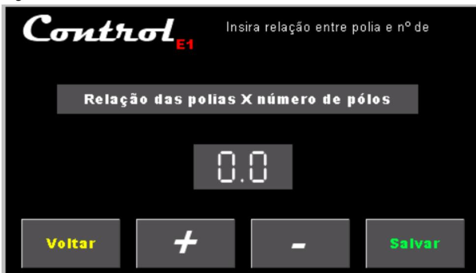
*Obs.; o sinal gerado pelo alternador cria uma referência de rotação do motor para o tacômetro do Control E1, mas para o perfeito funcionamento do instrumento é necessário dizer ao Control E1 qual relação de polias e quantos pólos magnéticos tem o alternador.*
